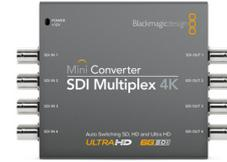
Der passende Konverter zur Umwandlung zwischen Geräten mit Quad Link HD-SDI, Dual Link 3G-SDI und Single Link 6G-SDI Ultra HD. Der Mini Converter SDI Multiplex 4K kann über seine vier 6G-SDI-Eingänge und vier 6G-SDI-Ausgänge in beide Richtungen umwandeln. Er konvertiert auch von Dual Link HD-SDI 4:4:4 und Single Link 3G-SDI.
