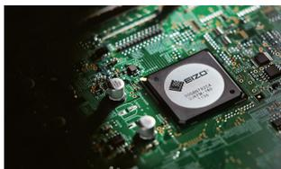
Der CG2420 verfügt über einen hochwertigen Microchip (ASIC, Application-Specific Integrated Circuit), den EIZO speziell für die besonderen Anforderungen des
